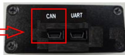
Port CAN connecter au VAE selon Connexion A ou Connexion B (voir explication ci-dessous)
