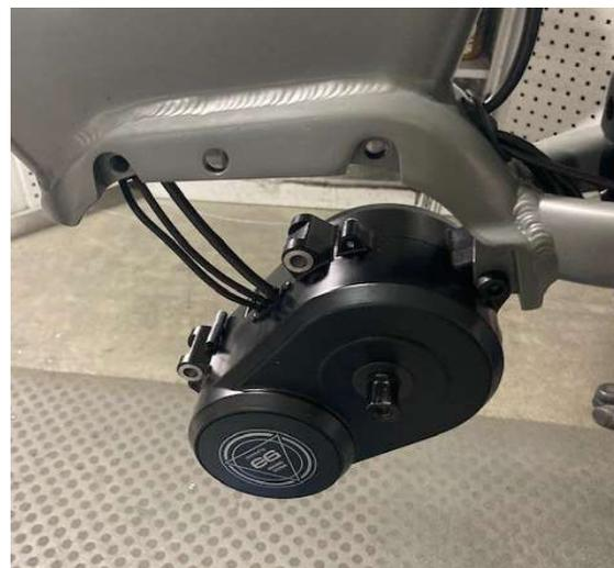
9. Déconnectez le faisceau moteur, les connectiques sont dans le cadre. Tirer délicatement sur les fils : **Info** : la conique rouge n'est pas connecté
