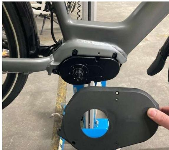
8. A l'aide du clé BTR de 6, procédez au démontage des 3 vis de fixation du côté gauche du moteur :
