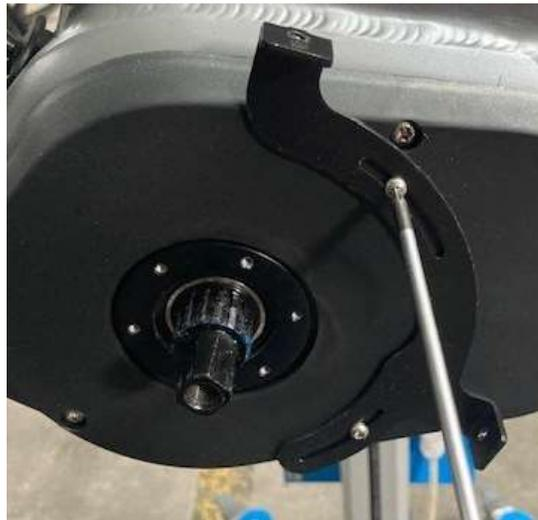
6. A l'aide d'une clé T25, procédez au démontage des 3 vis côté droit du carter moteur :
