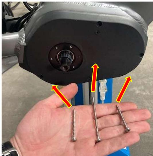
7. A l'aide d'une clé BTR de 3, procédez au démontage des 2 vis de carter moteur afin de pouvoir retirer le carter côté droit et gauche :
