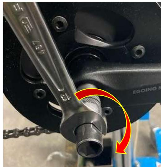
4. A l'aide d'une clé pour boîtier octalink, deviser l'écrou de fixation du plateau :
