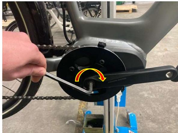
3. A l'aide d'un extracteur de manivelle et une clé plate de 13, procédez à l'extraction des manivelles : **Info** : pour plus de faciliter, maintenir de l'autre main la manivelle.
