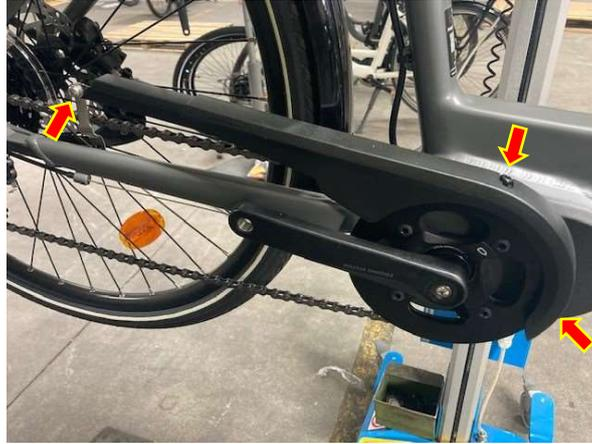
2. A l'aide d'une clé BTR de 8, procédez au démontage de la vis de la manivelle droite et gauche : **Info** : pour plus de faciliter, maintenir de l'autre main la manivelle.
