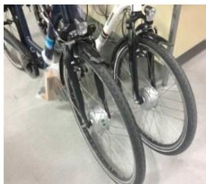
**Remarque:** si on test avec la 2<sup>ème</sup> roue d'un autre VAE, il faut extraire les connecteurs du moteur du cadre (voir les étapes ci-dessus).
