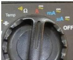
**Attention:** ne pas mettre le Multimètre sur la position Ampèremètre =court-circuiter la batterie.
