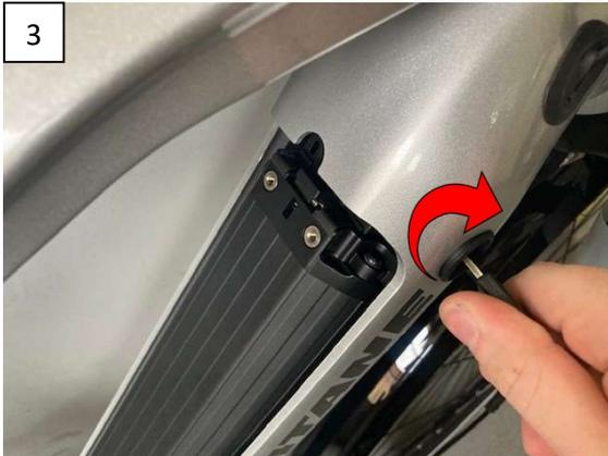
Déverrouillez le bloc batterie en tournant la clé vers la droite.
