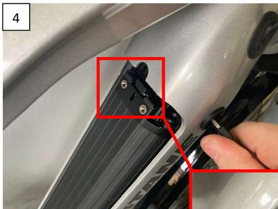
Déverrouillez maintenant la sécurité antichute du bloc batterie.
